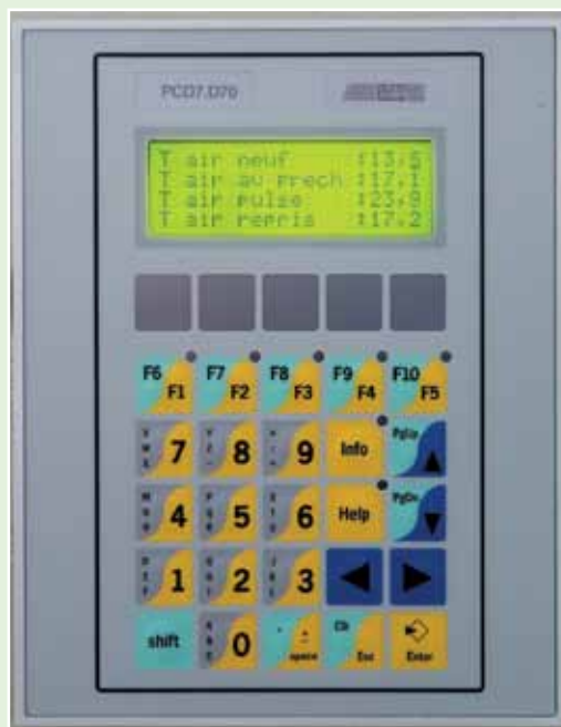
GTE a mis en place une GTC (gestion technique centralisée) dans le cadre de la garantie totale et la gestion d'énergie de ce bâtiment.
